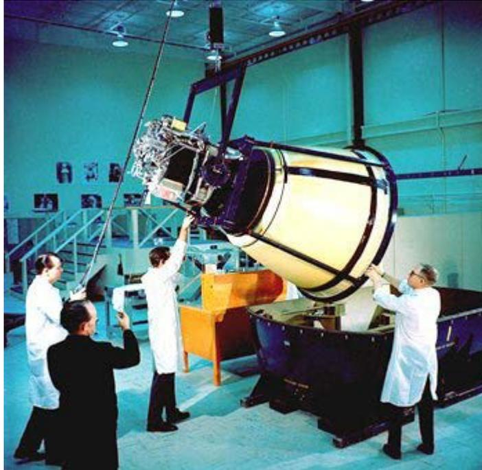
**Abbildung 76: Abstiegsstufen-Triebwerk der Mondlandefähre**
