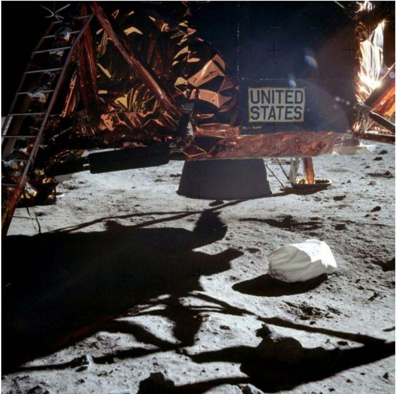
**Abbildung 31: Ungestörter Mondboden trotz Raketentriebwerkbelastung**
